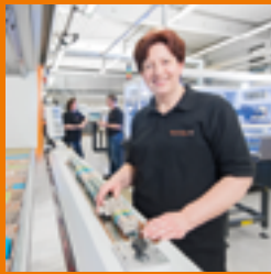
Beépítésre kész sorkapcsolécek legyártása
