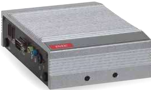
Webszerver 255 Modbus címhez vagy 255 impulzusmodulhoz (termékkód: SXWS255).
