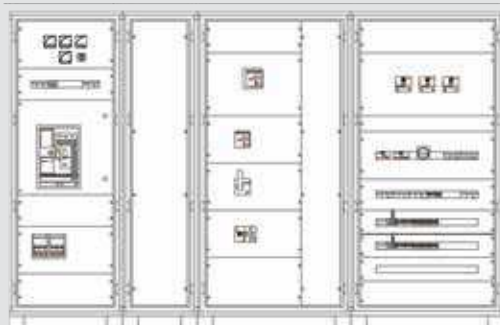
XL 3 4000 üres álló fém elosztószekrények és kábeltek IP30 – IK07, IP55 – IK08
