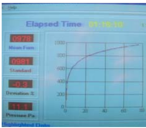
Vizsgálati hőmérsékleti görbe a DIN 4102 szabvány szerint
