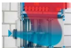
Légcsere szellőző betéten vagy szellőző fedélen keresztül
