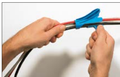
Helyezzen be egy vagy több kábelt a HAT behúzószerszám bemeneti nyílásába.
