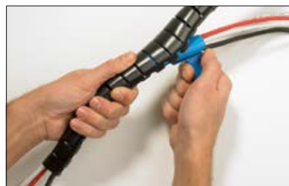
Egyszerűen csúszassa keresztül a HAT behúzószerszámot a Helawrap borításon.
