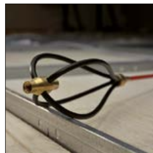
A seprű lehetővé teszi, hogy a rúd könnyedén átsuhanjon az akadályok felett.
