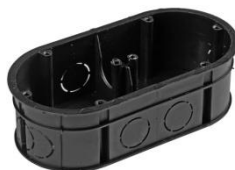
szerelvénydoboz alj 2-es, 140x70x40mm 12 helyen perforált IP20
