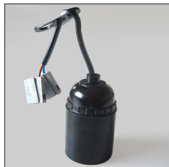
110-04/15cm/SK E 27 Renovierfassung 15 cm Zuleitung 2 x 0,75 Zugentlastung Steckklemme Schnuraufhänger Beschriftung: 230V, 75W
