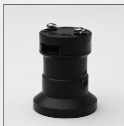
2427 E 27 Lichtkettenfassung mit Schnappdeckel und einer nicht lösbaren Sicherungsschraube für Flachleitung 13,5 x 5,5 mm oder 11 x 5 mm ohne Dichtring nur für Innenräume
