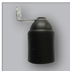
110B2A E 27 Fassung mit Außenbügel, glatt mit oder ohne Erdungsklemme Lochabstand 12 mm, Loch 3,2 mm
