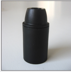
140K E 14 Fassung, glatt mit Isogewinde M10 x 1 Verdrehungsschutz außen Bohrung für Madenschraube 2,5x10
