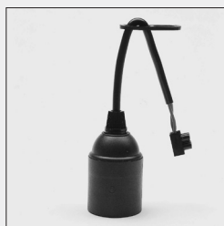
110-04/15cm E 27 Renovierfassung 15 cm Zuleitung 2 x 0,75 Zugentlastung Anschlussklemme Schnuraufhänger Beschriftung: 230V, 75W
