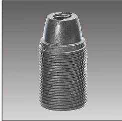
150K E 14 Schraubfassung mit Isogewinde M10 x 1 Verdrehungsschutz außen Bohrung für Madenschraube 2,5x10
