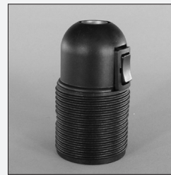
1200 D E 27 Druckschalterfassung Außengewindemantel Thermoplast mit Metallnippelgewinde M10 x 1 und Madenschraube
