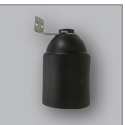
110B1A E 27 Fassung mit Außenbügel, glatt mit oder ohne Erdungsklemme Lochabstand 12mm, Loch 3,2mm
