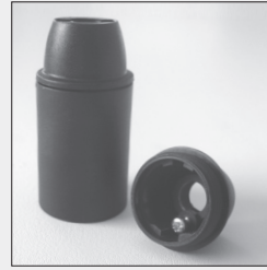
140KMS E 14 Fassung, glatt mit Isogewinde M10 x 1 Verdrehungsschutz außen mit eingedrehter Madenschraube
