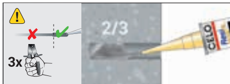
3. Az első 10 cm anyagot dobja el. Fecskendezze be a szükséges mennyiséget, (min. 2/3 lyuk)
