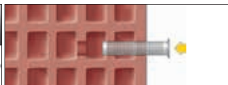
3. Helyezze be a szitahüvelyt
