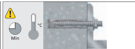
5. Bármilyen terhelés vagy nyomaték alkalmazása előtt tartsa be a kikeményedési időt
