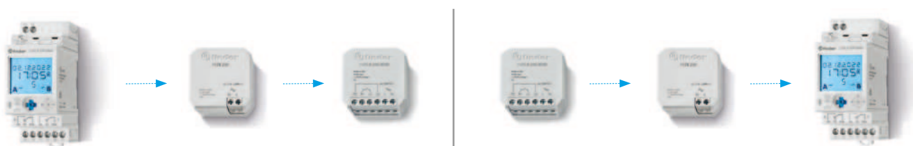
Alkalmazási példa jelerősítő (1Y.E8-as típus) használatára a távolabbi készülékek eléréséhez.
